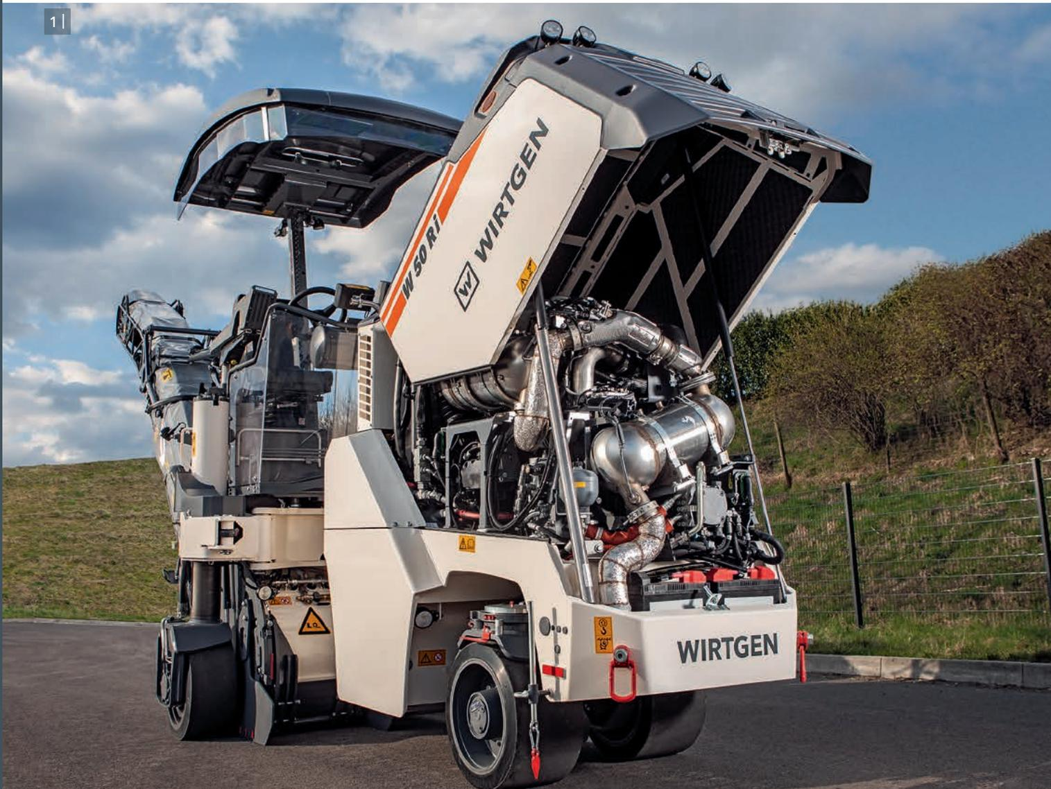
1 | Der Motor der W 50 Ri/W 60 Ri erfüllt die Abgasstufe EU Stage 4/ US Tier 4f.
