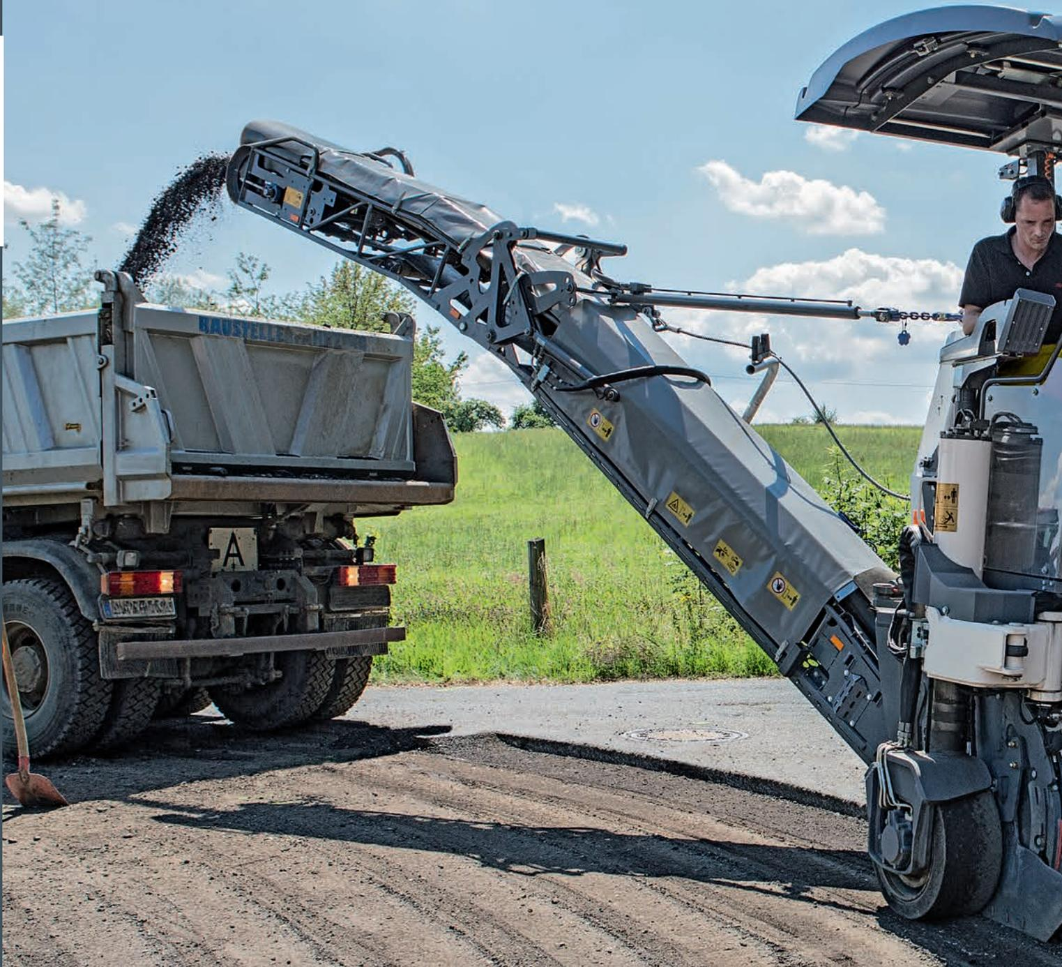
DIE LEISTUNGSSTÄRKSTE HALBMETER-KALTFRÄSE ÜBERZEUGT MIT EINEM EFFIZIENTEN BEDIEN-KONZEPT BEI EINER ARBEITSBREITE VON 0,5 ODER 0,6 M.
