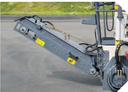
▲ Variable Abwurfhöhe für die sichere Verladung in die Schaufel eines Radladers oder Mini-Dumpers
