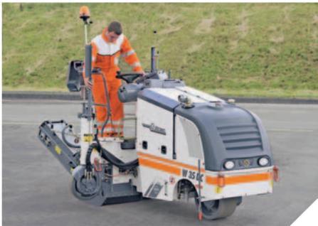
◀ Das einschwenkbare rechte Hinterrad erweitert das Einsatzspektrum der Maschine
