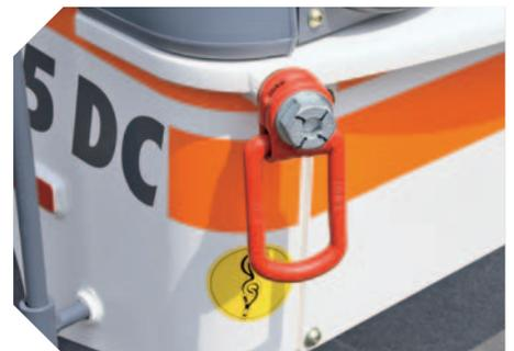
Mehrere durchdacht an der Maschine verteilte Halteösen für sicheren Transport ▲
