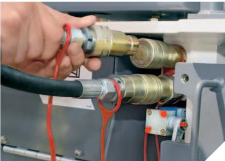
◀ Das Ladeband wird über Hydraulikschnellanschlüsse an die Maschine angekoppelt
