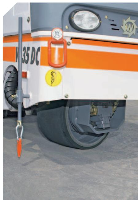
▲ Auf Wunsch wird die W 35 DC mit Allradantrieb ausgerüstet
