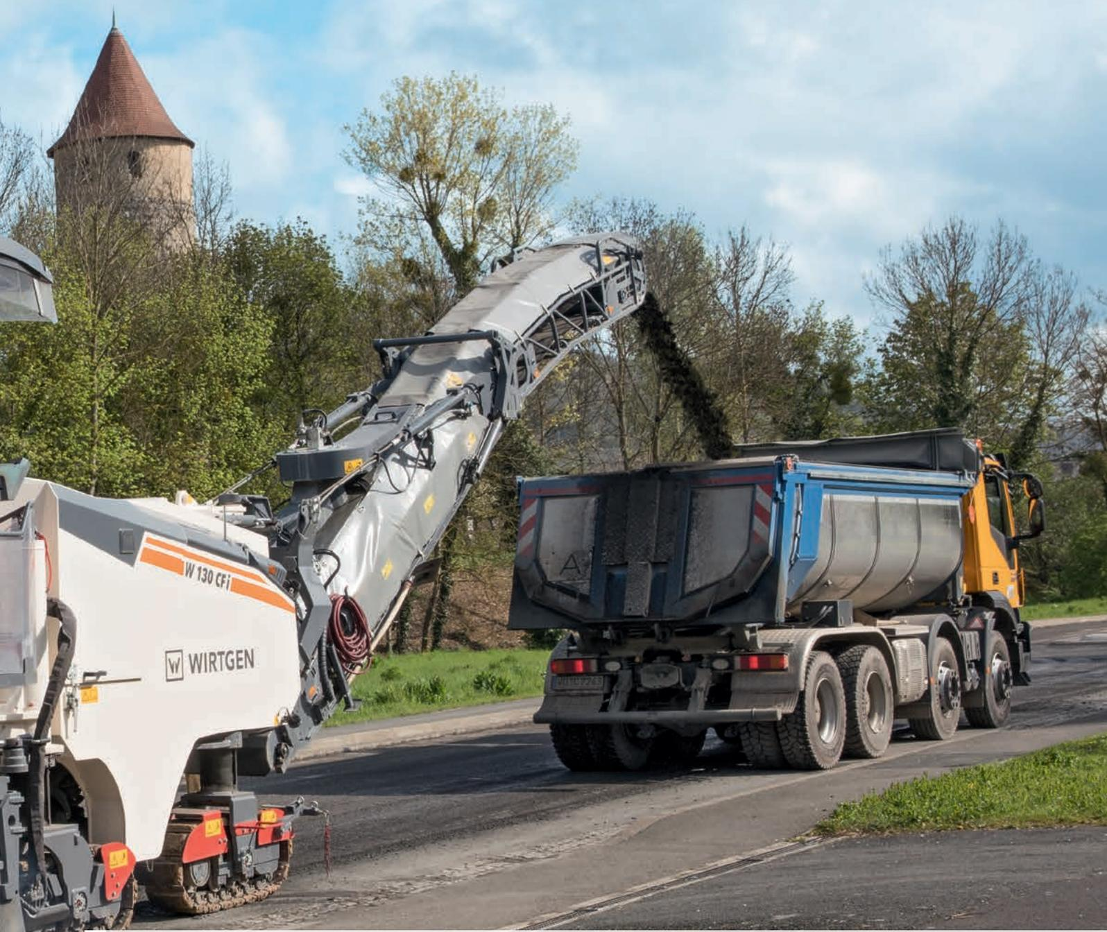
**DER FRONTLADER IN DER EINMETER-KLASSE ZEICHNET SICH DURCH HOHE LEISTUNGSSTÄRKE UND FLEXIBILITÄT BEI EINER ARBEITSBREITE VON 1,0 M, 1,2 M ODER 1,3 M AUS.**
